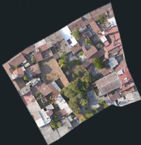
Ortofoto generada a partir de vuelo fotogramétrico con sistema de drone OPKUAV 5CM GSD.
